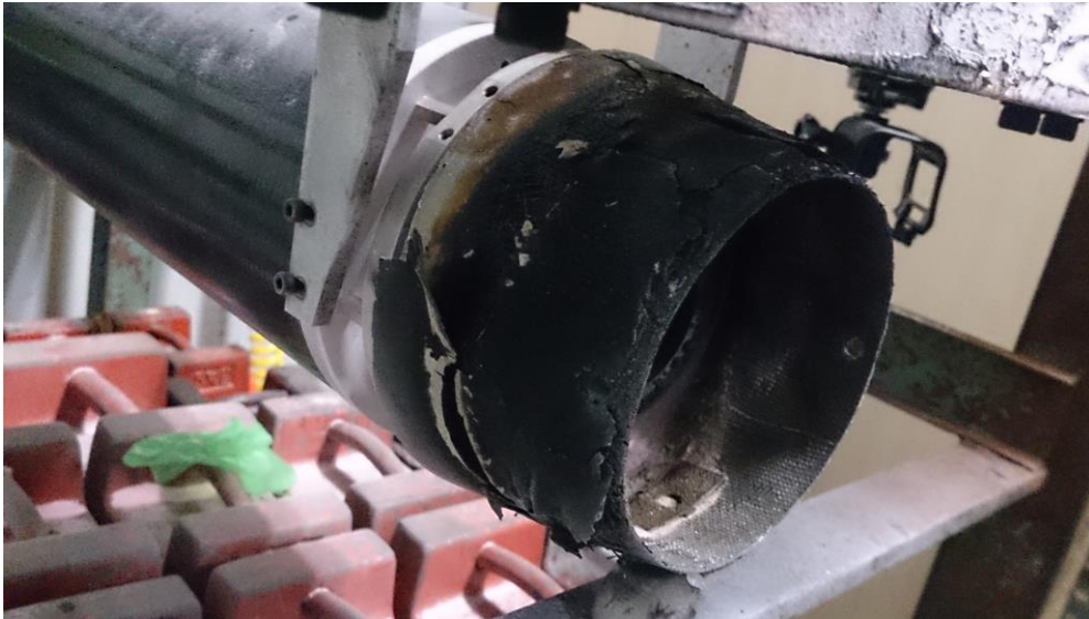
△領収試験にて焼け焦げたポートテイル。この後、燃焼終了後の延焼対策を行うこととなった。
