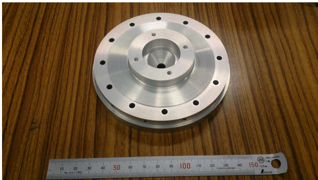
写真3 軽量化のため推力伝達用の機体部品とモータ構造部品を一体化した部品
