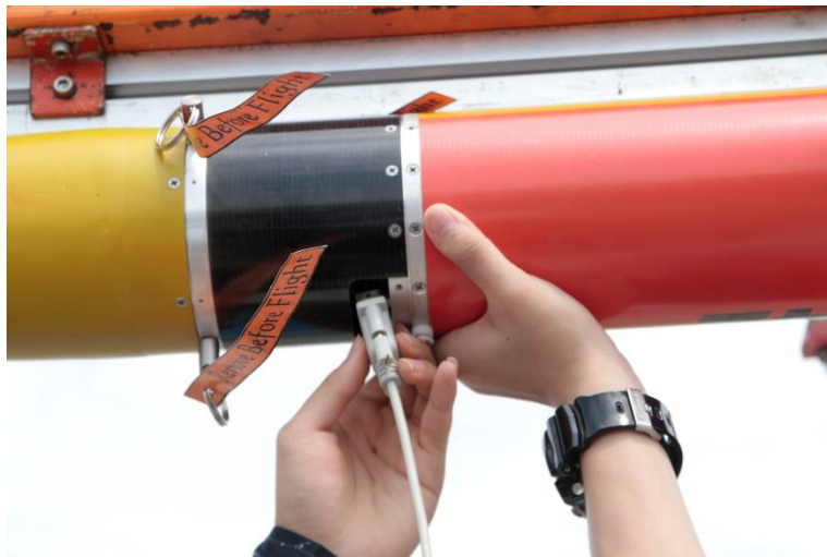
図 3.28 機体と接続中のアンビリカルケーブル
